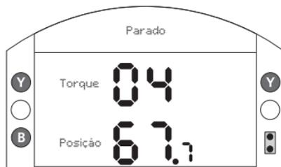
Fig. 4.4.3 Torque (D) + Posição
