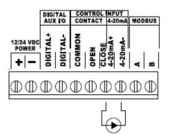
Figure 5. Wiring - L2e
