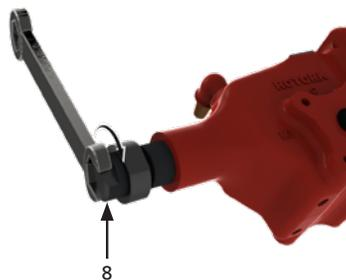
6. Überprüfen Sie die neu erhaltene Endstellung mit einem Hub in Schließrichtung.
