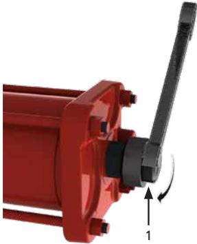
5. Zur Verringerung des Schwenkwinkels, drehen Sie die Anschlagsschraube (1) im Uhrzeigersinn
