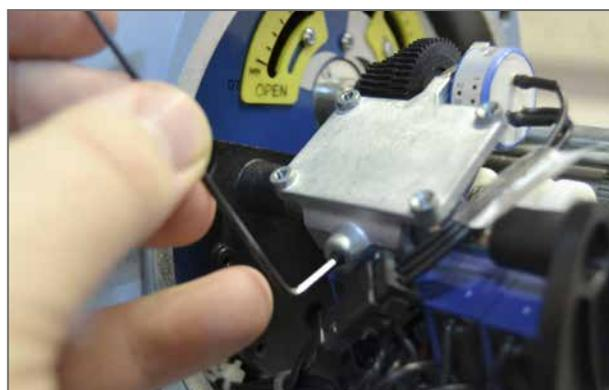
\*Клеммы потенциометра могут быть недоступны, если также установлен ПДИ СРТ. В этом случае важно обеспечить, чтобы потенциометр не проскальзывал во время полного хода арматуры. Ток должен изменяться в пределах 4-20 мА, однако может потребоваться настройка. Инструкции по настройке смотреть на следующей странице.
