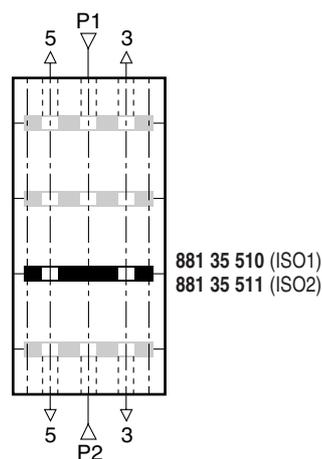
Pour réaliser ce montage, l'alimentation d'une plaque-sélecteur avec liaison sur les orifices 3 et 5 est nécessaire.
