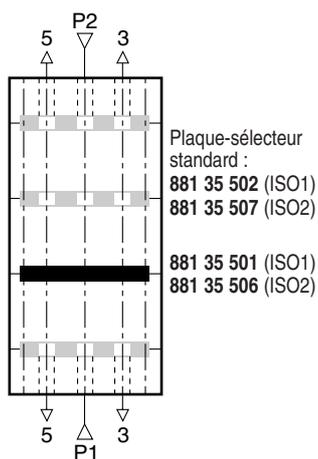
Pour réaliser ce montage, l'alimentation d'une plaque-sélecteur d'obturation des canalisations 1-3-5 est nécessaire.
