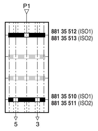
L'utilisation d'une plaque-sélecteur orifice 1 + une plaque-sélecteur orifices 3 et 5 montées contre les embouts permet (en ISO 1) de réaliser le montage ci-dessus sans avoir à boucher les orifices.
