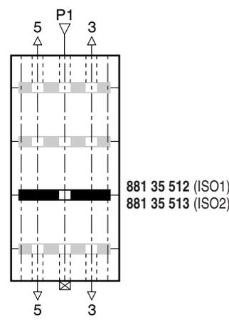
Pour réaliser ce montage, l'alimentation d'une plaque-sélecteur orifice 1 est nécessaire. Elle permet d'isoler les échappements tout en conservant l'alimentation de pression commune. Mettre un bouchon sur l'autre extrémité.
