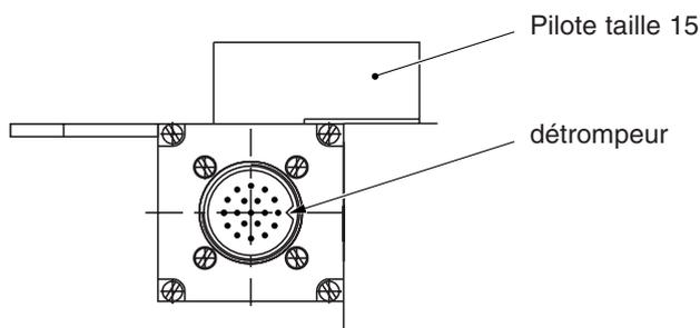
La mise à la terre est à réaliser à travers la broche 12 du connecteur.
