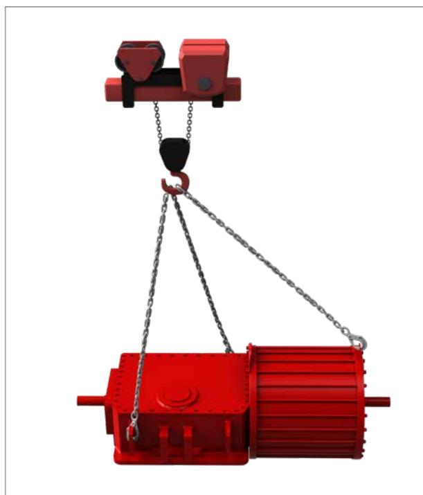
Fig 7.4 Levage (actionneur à double effet taille 200 - 350)
