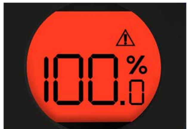
Fig. 15.2 Luce lampeggiante dell'attuatore con i colori rosso e bianco in modo alternato in caso di assenza di alimentazione elettrica
