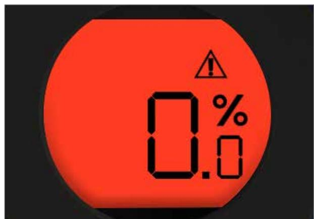
Fig. 25.2 Luce lampeggiante dell'attuatore con i colori rosso e bianco con RPP attivo durante l'assenza di alimentazione elettrica
