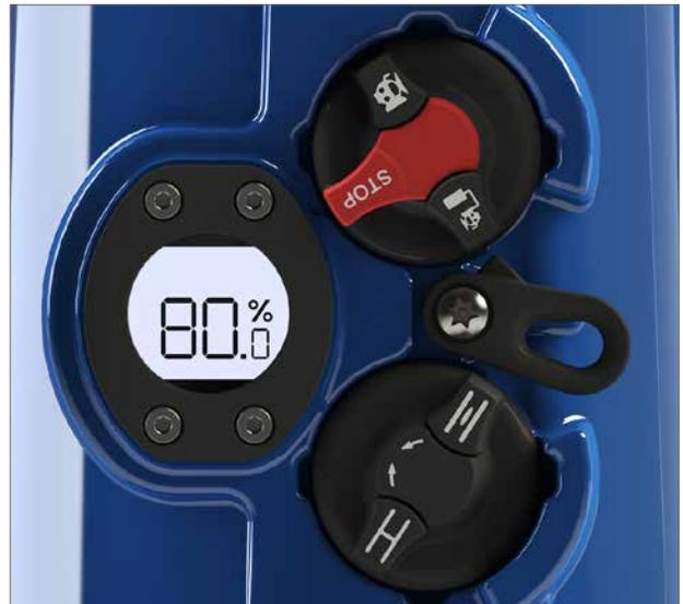
Fig. 25.1 Actionneur placé en position de 'STOP'
