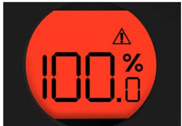
Fig. 15.2 L'actionneur clignote alternativement en rouge et blanc quand a lieu une coupure d'alimentation
