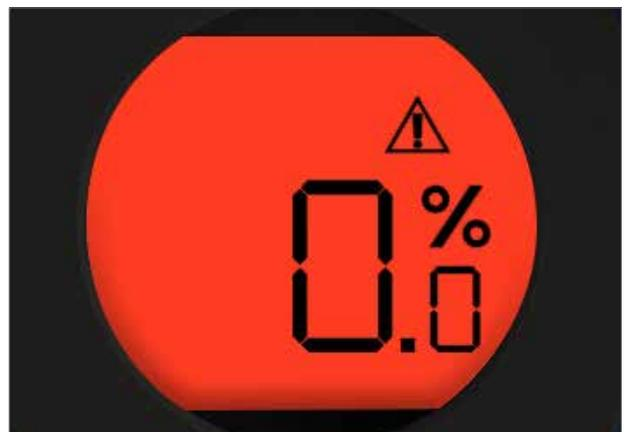
Fig. 25.2 L'afficheur de l'actionneur clignote en rouge et blanc quand le RPP est actif lors d'une interruption de l'alimentation.
